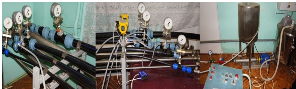
Установка для исследования переходных процессов и гидроудара при транспортировании пищевых продуктов по трубопроводам
