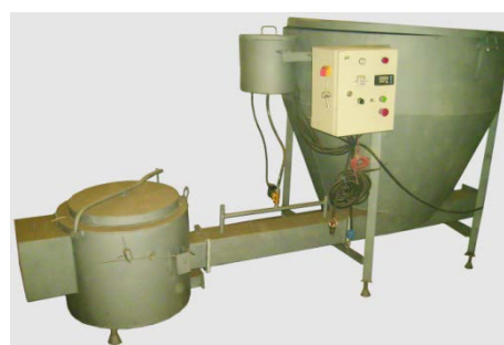
Топочный агрегат АТА-50 (слева), общий вид вибропневмосортировальной машины (справа)
